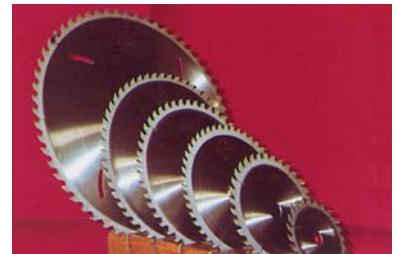
La particolare forma degli intagli silenziati e l'inserimento negli stessi di un particolare materiale fono assorbente riducono notevolmente le vibrazioni, causa della rumorosità e della finitura della lama circolare. La diminuzione delle vibrazioni, unita al nuovo disegno del tagliente, consente inoltre un incremento della durata di taglio della lama pari al 20%.
